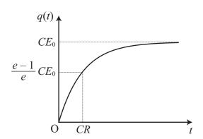
(b) 電流は  $I(t) = \frac{1}{R} \left( E_0 - \frac{q(t)}{C} \right) = \frac{1}{R} \left[ E_0 - E_0 \left( 1 - e^{-\frac{t}{CR}} \right) \right] = \frac{E_0}{R} e^{-\frac{t}{CR}}$  となる。 あるいは,問 4(a) で求めた I(t) を微分して, $I(t) = \frac{dq(t)}{dt}$  から求めてもよい。 グラフは以下のようになる。
