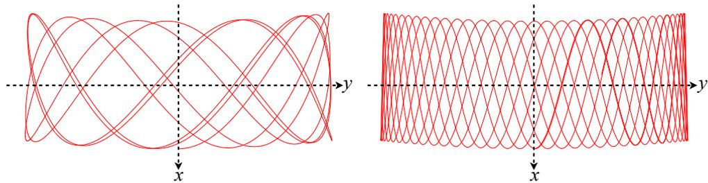
図 A1：小球の軌跡。図中の  $x$  軸と  $y$  軸の交点 (原点) はつりあいの位置を表す。(左図)  $\omega_a$  と  $\omega_b$  の値が近い時の軌跡。(右図)  $\omega_a \gg \omega_b$  の時の軌跡。
