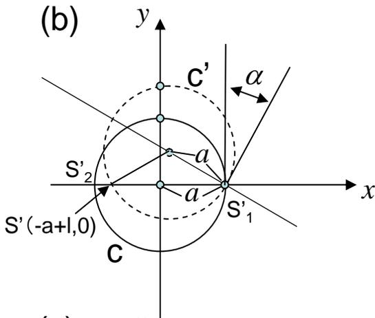
図のような同じ半径を持つ円C' とx軸との交点が、もとの出射スリット孔からどれだけずれるか求めればよい。
