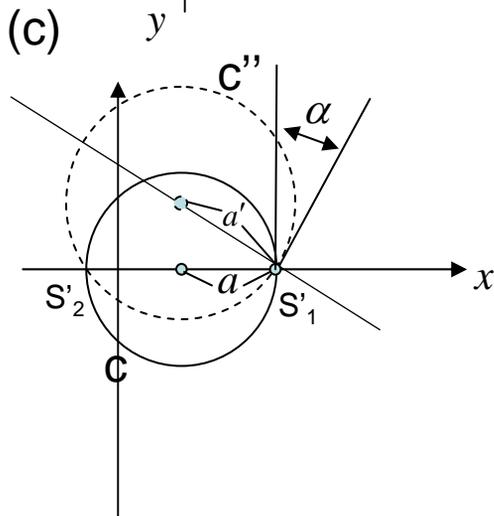
図のような異なる半径の円C''がもとの円Cと入射スリット孔と出射スリット孔の2点で交差していればよい。
