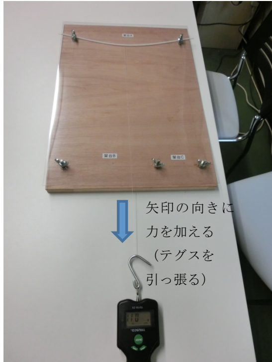
プラスチック棒に力を加えてたわませる
