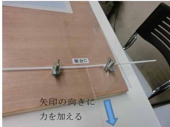
架台 C にプラスチック棒を設置し、力を加えてたわませる
