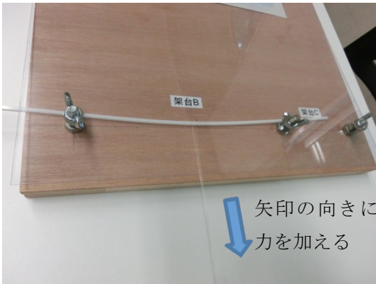
架台 B にプラスチック棒を設置し、力を加えてたわませる
