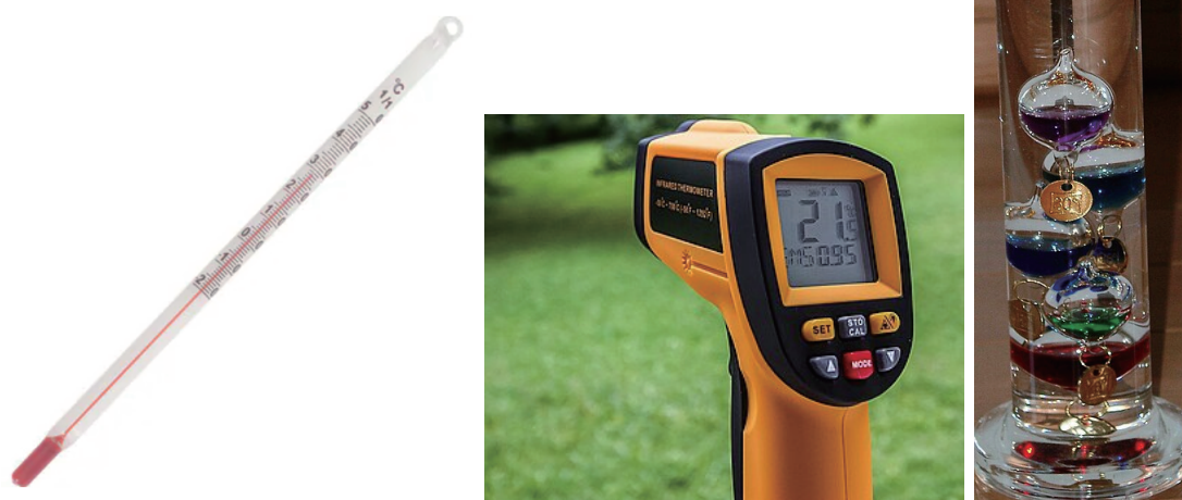
図 5: 棒温度計 (モノタロウ), 放射温度計, ガリレオ温度計 (WikiPedia)
